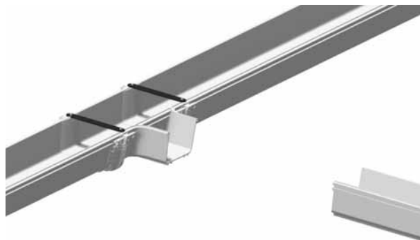
Система каналов с разрывом между противоположными секциями
