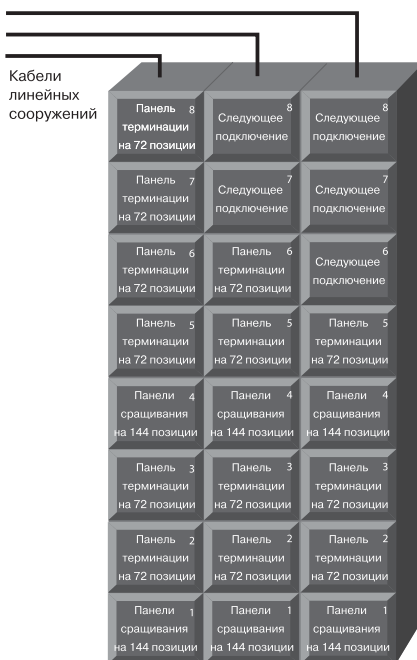
Оптический кросс со строкками и выводами, расположенный в центральной станции. (3) кросса, общая емкость: 1080 выводов.
