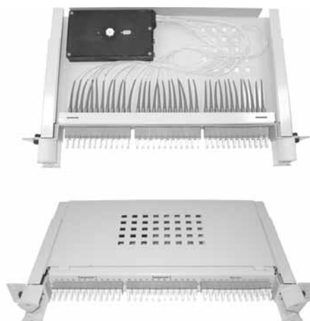
19-дюймовый модуль контроля 1RU
