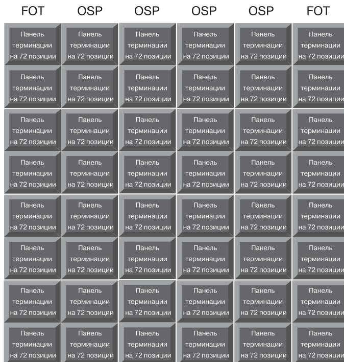
Рисунок 16. Конфигурация кроссирования оптического кросса с соотношением OSP:FOT (линейные сооружения: оконечное оптическое оборудование) 2:1
