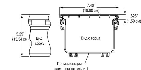
Защелкивающаяся крышка для прямой секции 6" FGS-MSSC-B/G
