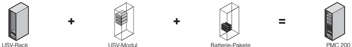
Kleinstmögliche Grundfläche benötigt ein Rack mit 3 Modulen (2+1 Redundanz) und Batterien mit Autonomiezeit integriert in einem Rack. Rittal PMC 200 ermöglicht die Integration von bis zu 5 Modulen (4+1 Redundanz) in einem Rack. Für diese Anordnung wird ein zusätzliches Batterie-Rack benötigt. Die Autonomiezeiten können flexibel Ihren Anforderungen anpassen werden.
